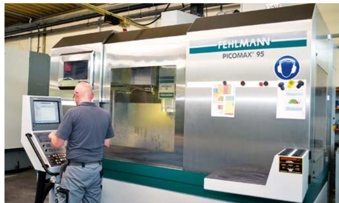
**Kraftpaket:** Die Picomax 95 von Fehlmann wird bei Pfefferkorn fürs Hochvorschubfräsen eingesetzt.
